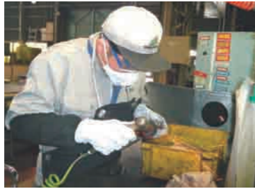
レーザーで切った鉄板の切口に付着した酸化被膜をグラインダーでパフ掛けるAサン
